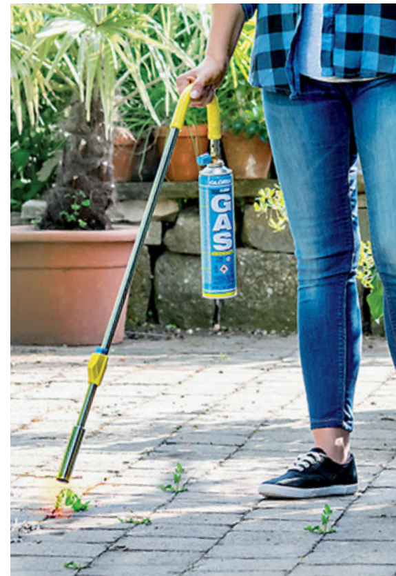
Gasflamme gegen Unkraut. Blätter müssen nicht verkoken. Sie sterben schon durch die Hitze.
