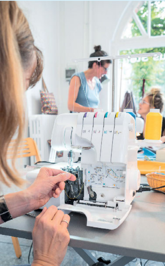
Nicht verheddern. Zeichnungen an den Overlockgeräten erleichtern das Einfädeln der vier Garne.
