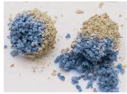
Zerbrösel. Die Klumpen bei Cat's Best zerfallen leicht. Den künstlichen Urin haben wir zum Sichtbarmachen blau eingefärbt.
