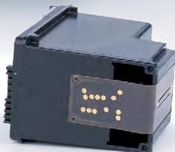
**Flexibel.** Wechselbare Resttintenbehälter wie beim Epson XP-8600 (oben) und herausnehmbare Druckköpfe (links) wie beim HP Smart Tank 655 können die Lebensdauer von Druckern erhöhen.
